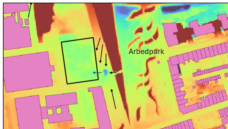
Figuur 17: Afwatering Arbedpark. Het water (zwarte pijlen) zal zich in eerste instantie verzamelen op het kruispunt van het Puntfabriekpad en Blauwfabriekpad. Bij zeer zware buien zal het water ook richting de projectzone vloeien. Dit water zal in de zuidoostelijke hoek van de projectzone toestromen.
